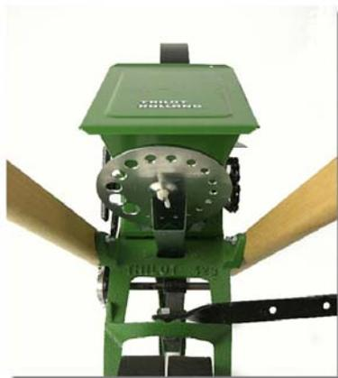
La cantidad de semillas se puede regular a base de girar el disco de semillas. La deseada profundidad de siembra se obtiene graduando el pie de semillas.
